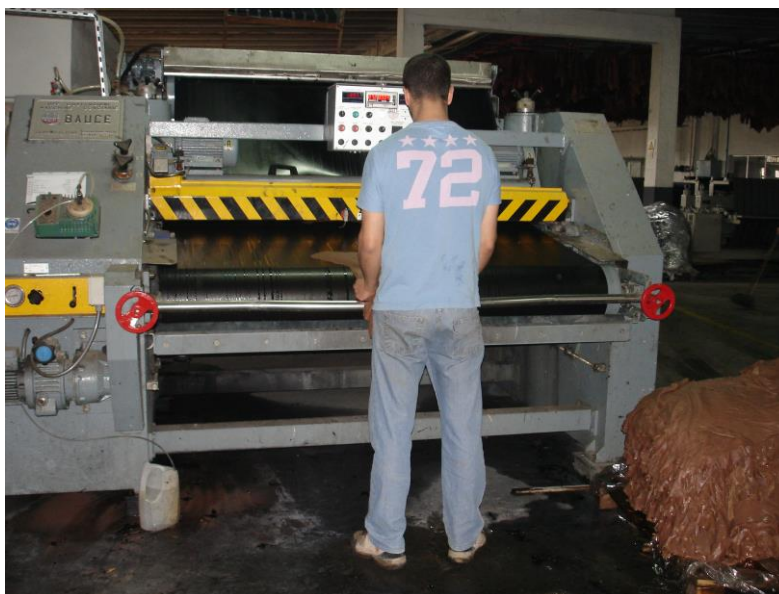
Figura nº 07 | Operação da Máquina de Escorrer
