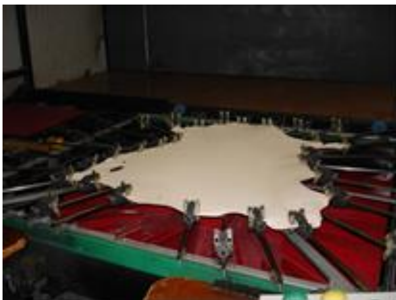
Figura nº 10 | Operação da Máquina de Pregar
